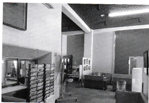
ロビー。階段、廊下は不燃間仕切りによって区画された
